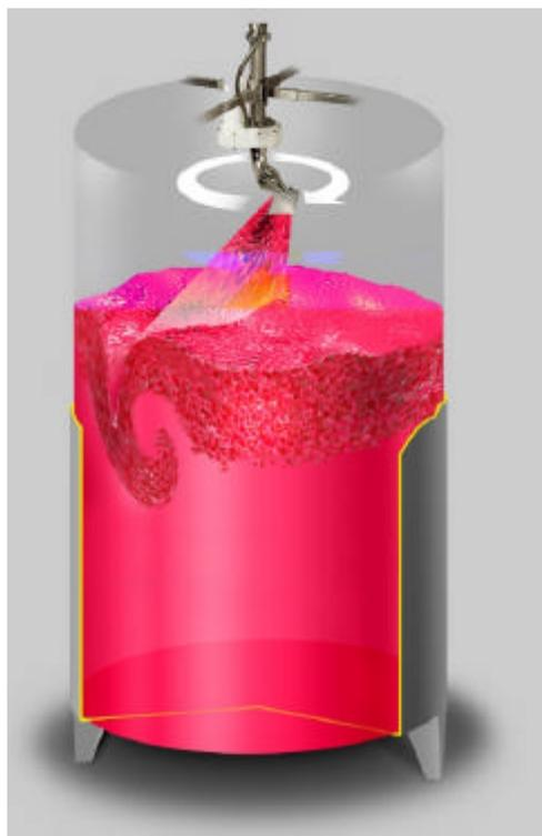
Sul foro di uscita, all'estremità del braccio, vi è posizionato un dispositivo atto a ridurre la forza d'impatto impressa dalla pompa tra mosto e cappello, si tratta di un dispositivo somigliante ad una mano che posta davanti all'ugello rende il getto come laminare e la bagnatura molto soffice, ricreando un effetto simile alla pioggia.
